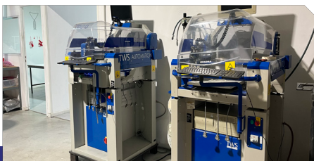
Robots pour l'implantation des composants électroniques et Leds.
