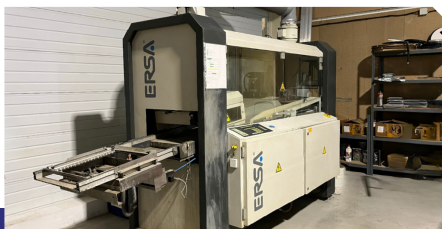
Vague de brasage pour souder les composants sur les circuits imprimés
